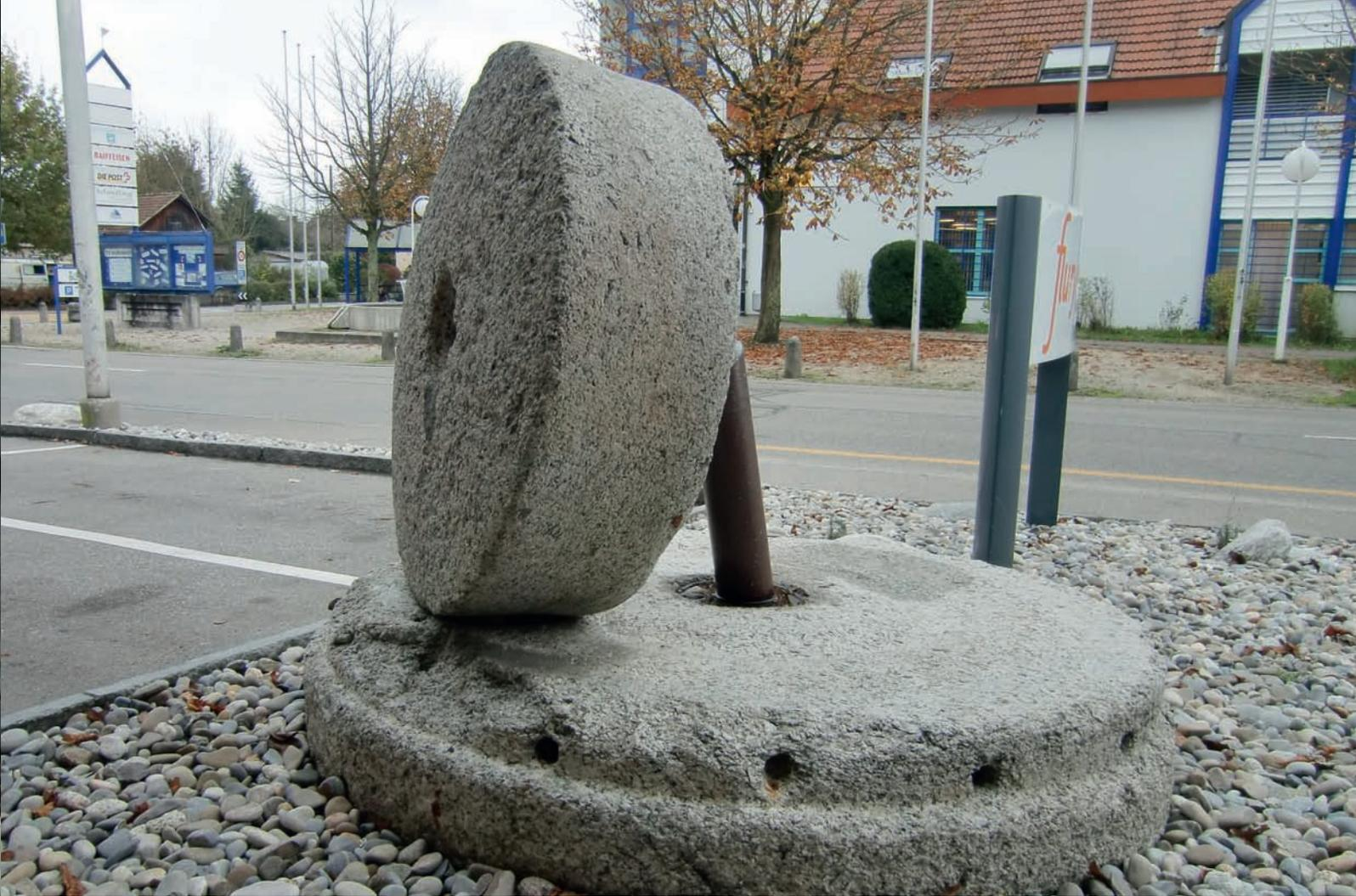
Eine mächtige Konstruktion zur Gewinnung von Ölen aller Art, angetrieben vom Oelibächli, einer Abzweigung vom Sagibach.
